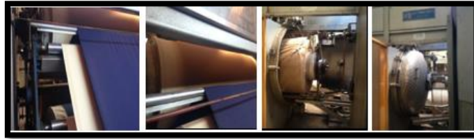
Şekil 3. Dokuma kumaşın kade makinesinin buhar kazanında işlem görmesi
