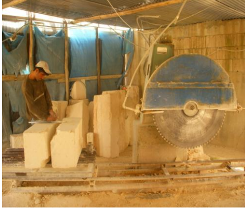
Şekil 6. Atölyelerde büyük blokların küçük bloklara bölünmesi ve stoklanması.
