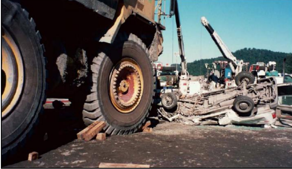
Şekil 2. Nakliye kamyonu operatörünün yakınındaki daha küçük bir aracı görememesi sonucu oluşan bir kaza.
