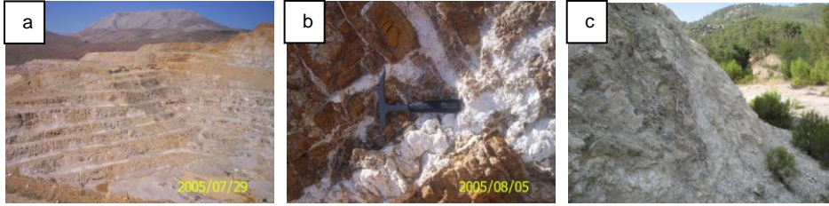
Şekil 5. (a) Helvacıbaşa ocağının genel görünüşü; (b) ocaktaki stokvörk manyezit; (c) Sarıkavak dolayında mostra veren manyezit;
